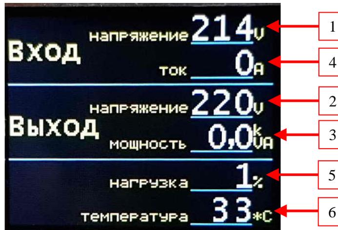
Рис.№3. Индикатор в режиме подробного отображения электрических параметров.
