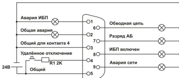
**Рисунок 15 – Электрическая схема организации контроля и управления ИБП с электропитанием от источника постоянного тока напряжением +24 В**
