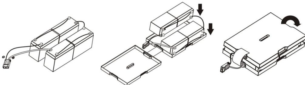
Рисунок 20 – Последовательность установки аккумуляторов в контейнер ИБПАТС 2000 R-BE
