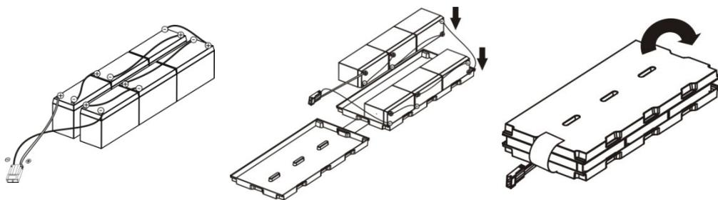
Рисунок 21 – Последовательность установки аккумуляторов в контейнер ИБПАТС 3000 R-BE
