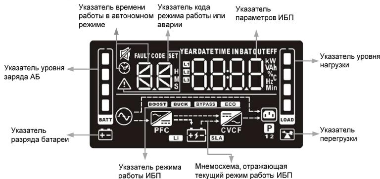
Рисунок 2 – Внешний вид LCD-дисплея ИБП
