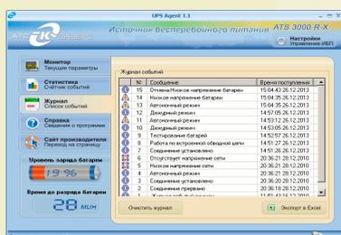
**Дистанционный контроль и управление** по последовательному порту RS-232 или USB с помощью ПО UPS Agent, посредством релейного интерфейса AS/400, а так же мониторинг и управление в сетях Internet/Intranet по протоколам HTTP и SNMP при помощи WEB/SNMP-адаптера WEBtel II ES AUX.
