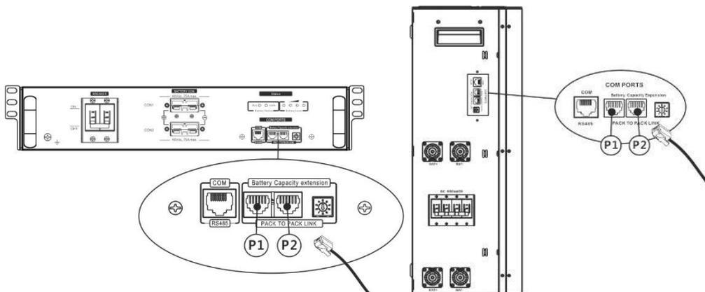
Шаг 2: Воспользуйтесь кабелем RJ45 для соединения инвертора и литиевой батареи (входит в комплект поставки модуля батарей).
