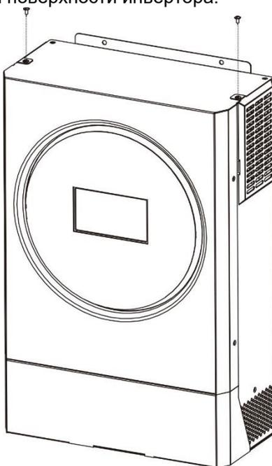
**Шаг 2.** После этого, можно снять защитную решетку и воздушный фильтр как показано на рисунке ниже.
