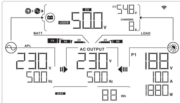
Энергия от фотоэлектрических модулей обеспечивает заряд аккумуляторных батарей, электросеть и энергия от фотоэлектрических модулей обеспечивают питание нагрузки.
