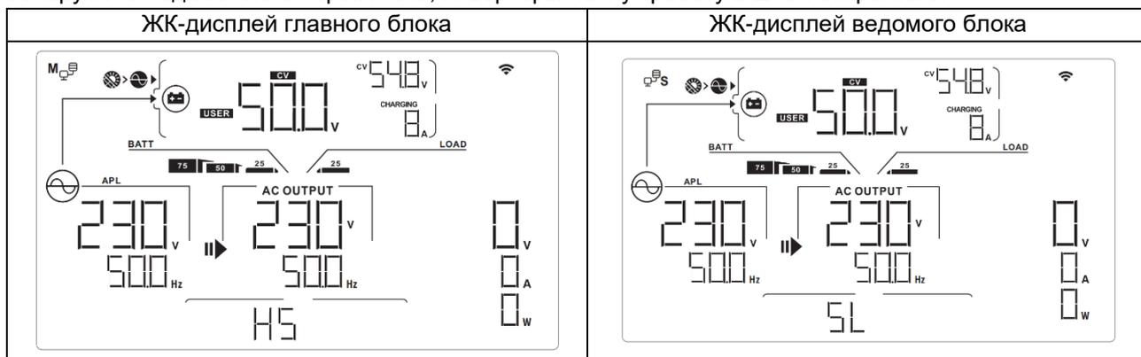
Шаг 5. Если оповещения о неисправностях больше не появляются, установка параллельной системы полностью завершена.
