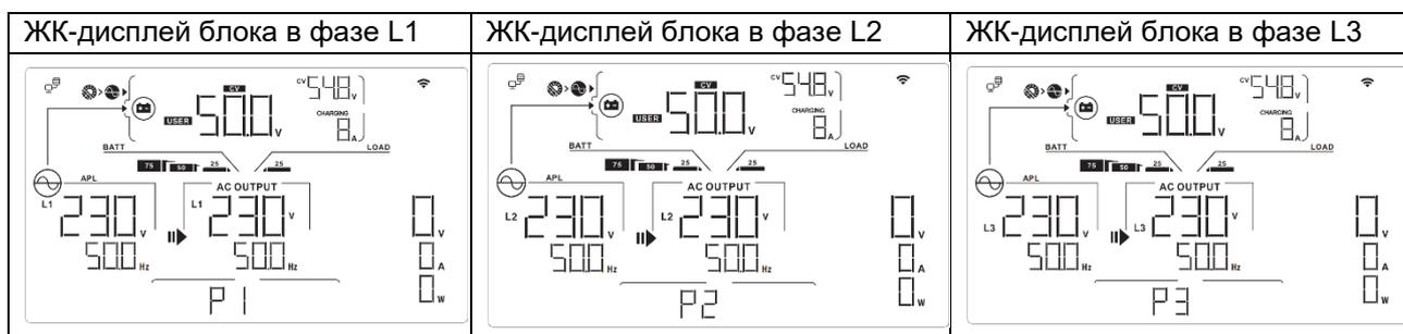
Шаг 5. Если оповещение о неисправности больше не появляется, установка системы для питания трехфазного оборудования полностью завершена.
