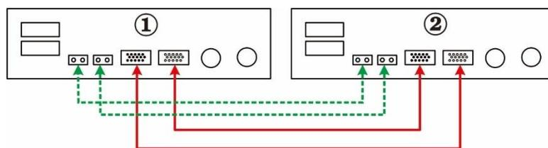
Три параллельно соединенных инвертора
