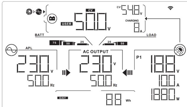
Энергия от фотоэлектрических модулей обеспечивает заряд аккумуляторных батарей, питание нагрузки и экспорт электроэнергии в сеть.
