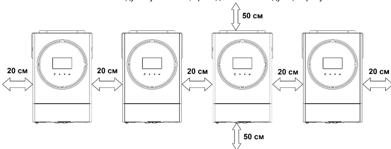
**ПРИМЕЧАНИЕ.** С целью отвода тепла и для обеспечения соответствующей циркуляции воздуха, зазор с боковых сторон блока должен быть приблизительно 20 см, а сверху и снизу блока — приблизительно 50 см. Все блоки должны быть расположены на одной высоте.
