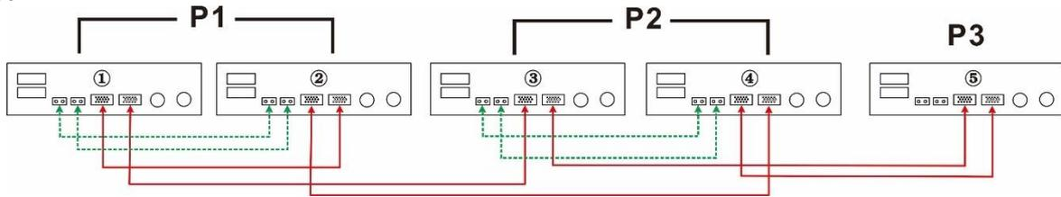
Два инвертора для одной фазы и по одному инвертору для остальных двух фаз:
