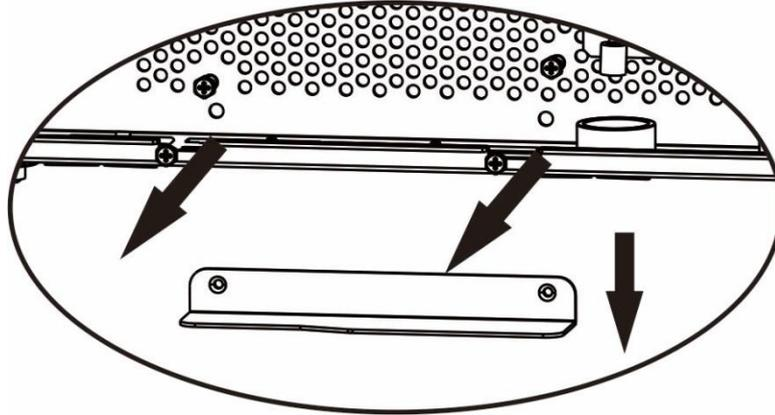
**Шаг 4.** Установите плату параллельного соединения и закрепите ее с помощью 2 винтов.
