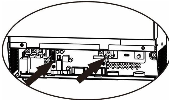
**Шаг 5.** Подключите обратно 2-пиновый и 14-пиновый кабели к соответствующим разъемам на плате параллельного соединения как показано на рисунке ниже.
