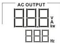
Индикация напряжения и частота на выходе, нагрузка в ВА, нагрузка в Ваттах
