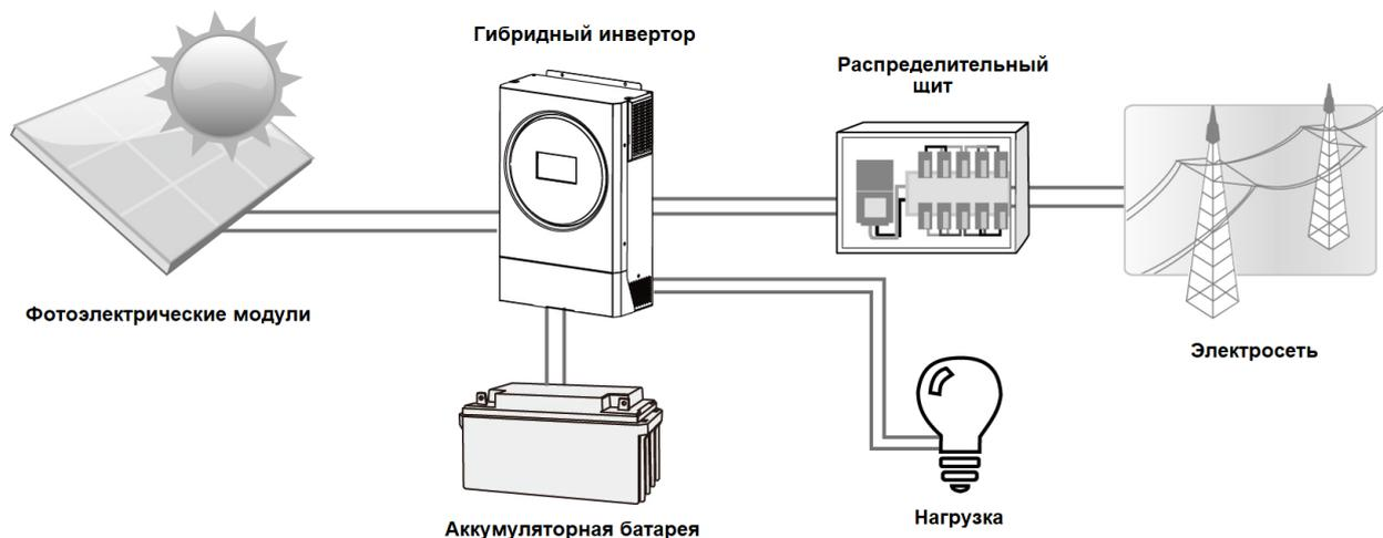
**Рисунок 1 Структурная схема подключения гибридной солнечной электростанции**
