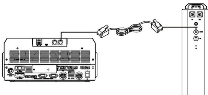
Примечания для систем с параллельным соединением инверторов:
