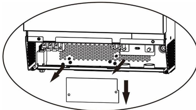
**Шаг 3.** Открутите 2 винта и снимите защитную заглушку для разъемов параллельного соединения как показано ниже.
