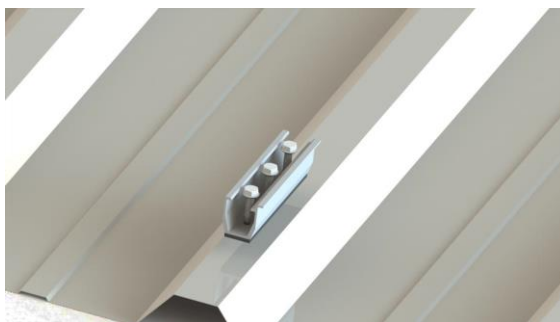
Рисунок 30. Установка мини-рейла на кровлю
